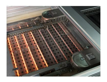
回流焊保养注意事项:为避免清理炉膛不当,造成燃烧或炸开,严禁使用高挥发性溶剂清理炉膛内外,若 无法避免使用高挥发性溶剂如酒精等,请清理完毕后,必须确保此类物质挥发完后方可使用设备。保养前必须 先将各零部件上的助焊,灰尘,污垢或其他异物清理干净在上油!特别注意的是,我们在对回流焊进行日常保 养的同时,如发现机器有故障问题时,不能擅自维修,必须及时通知设备管理人员处理。同时在保养的过程中 必须注意安全作业,切勿不规范操作。
