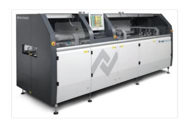
回流焊设备回流焊接区的作用在这区域里加热器的温度设置得高,使组件的温度快速上升峰值温度。在回流段其焊接峰值温度视所用焊膏的不同而不同,般推荐为焊膏的溶点温度加20-40℃。对于熔点为183℃
